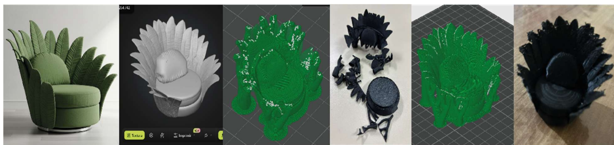
Figura 2: Cadeira Samambaia - Testes de impressão 3D de modelos gerados por IA
