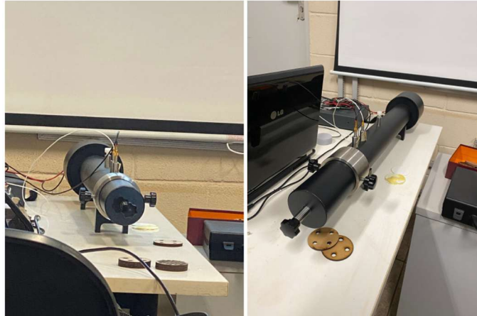
Figura 6: Tubo de impedância utilizado nos testes.
