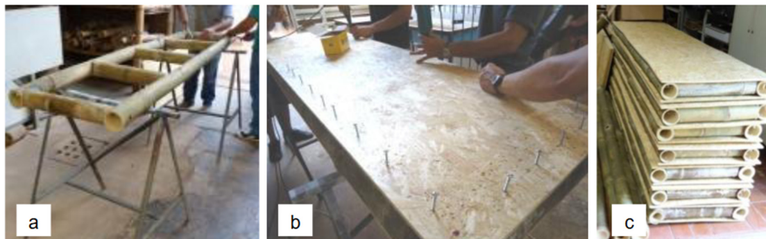
Figura 8: Montagem da ossatura (a), parafusos auto atarrachantes (b) e painéis armazenados (c).
