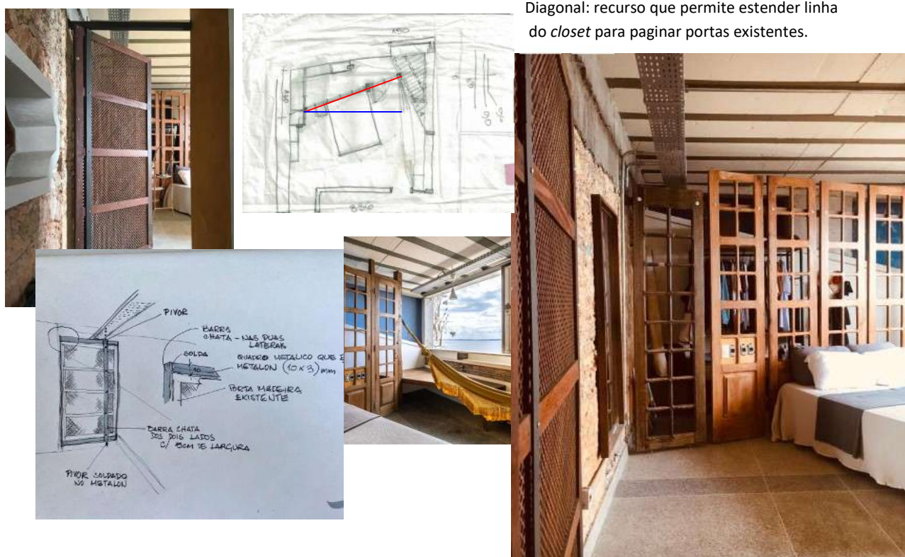
Figura 9: Composição de desenhos e imagens do processo de ajuste para a inserção das esquadrias, como conformadoras do espaço do closet e como porta de acesso do quarto. Apartamento Humaitá.
