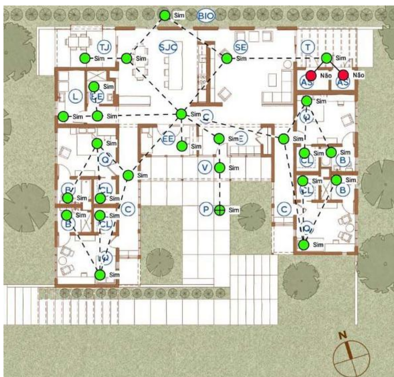
Figura 9: Planta-tipo residencial do Sweetwater Spectrum - Grafo planar da classe Sequenciamento Espacial Lógico
