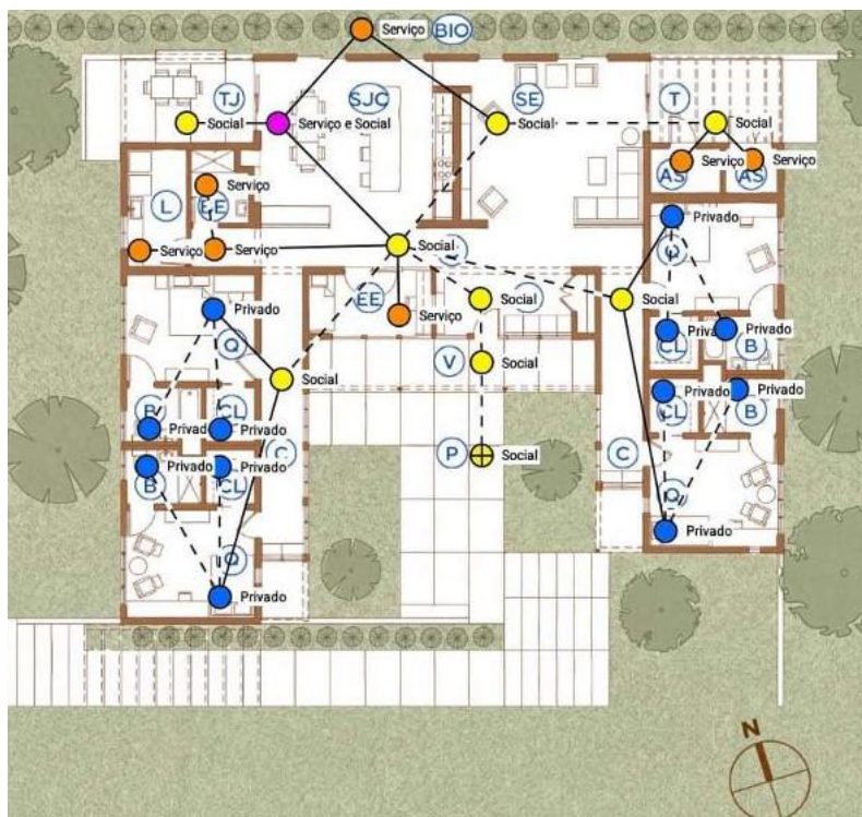
Figura 3: Planta-tipo residencial do Sweetwater Spectrum - Grafo planar da classe Setor Funcional
