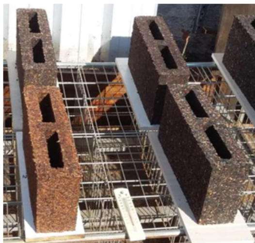
Figura 10: Desforma e cura dos blocos.
