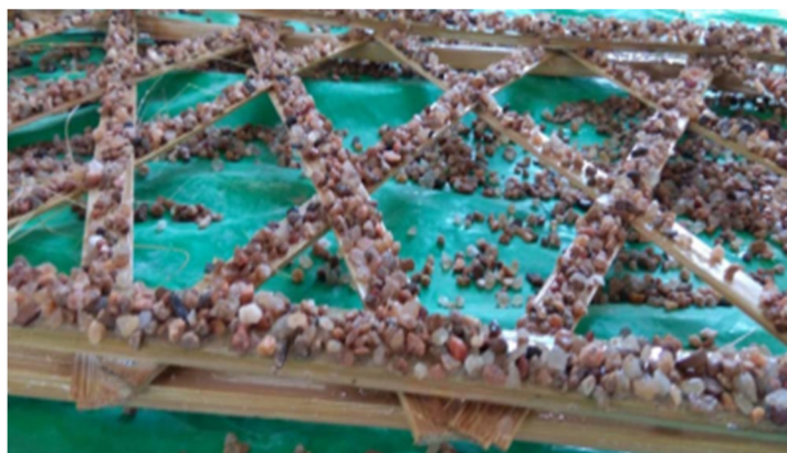
Figura 9: Esteira de bambu tratada com água de cal revestida com epóxi e areia
