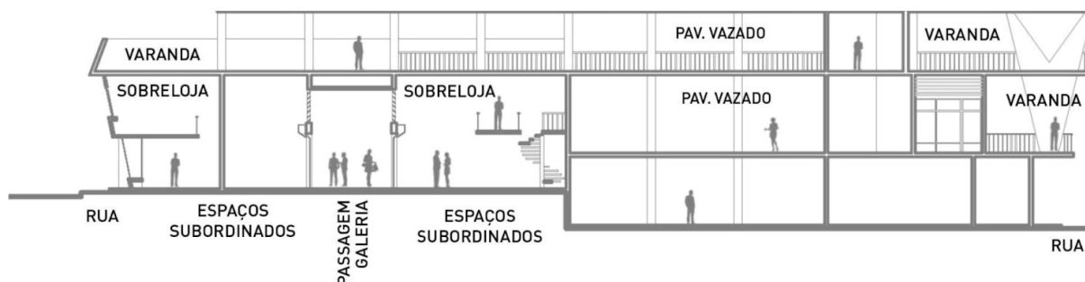
Figura 28: Edif. Walfrido Antunes (1956). Corte da base comercial com galeria interna. Projeto: Waldecy Pinto.
