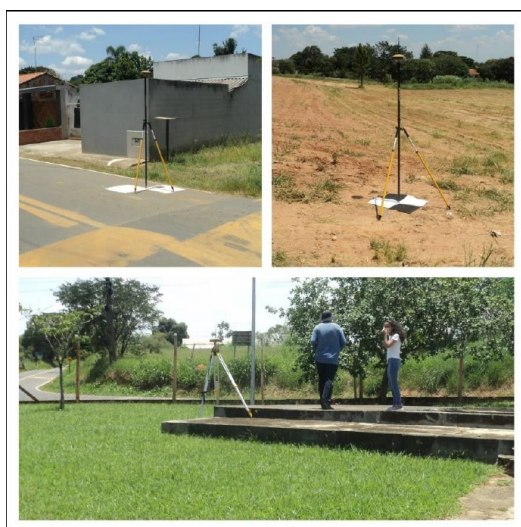
Figura 6 – Alocação da estação base do GNSS geodésico e coleta de pontos de controle com a estação de levantamento. Fonte: Autores (2022).
