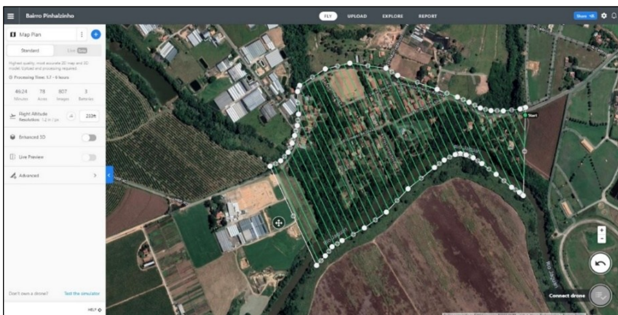
Figura 4 – Plano de voo organizado no site DroneDeploy. Fonte: Autores (2022).
