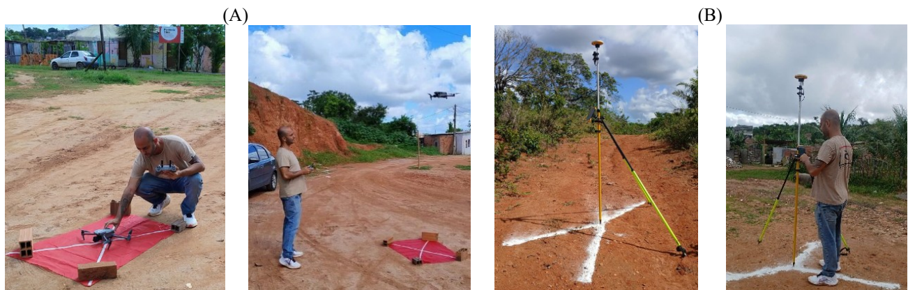
Figura 3 – (a) Levantamento fotogramétrico (b) Aquisição pontos de checagem
