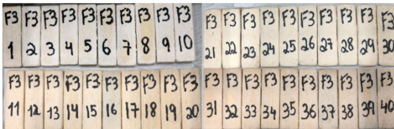
Figura 6 – Sinterização das peças esmaltadas na temperatura de 1150°C – (F3).
