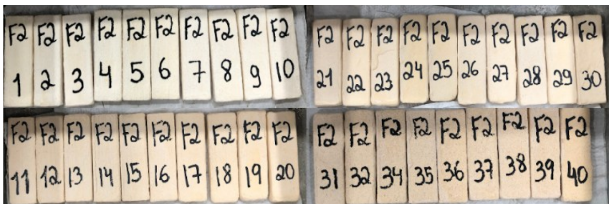
Figura 5 – Sinterização das peças esmaltadas na temperatura de 1100°C – (F2).
