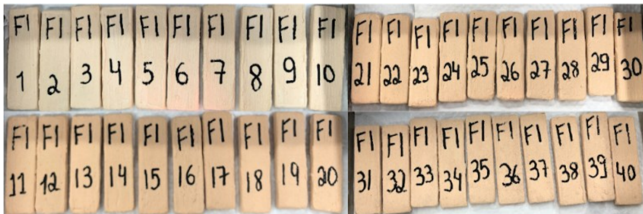
Figura 4 – Sinterização das peças esmaltadas na temperatura de 1000°C – (F1).
