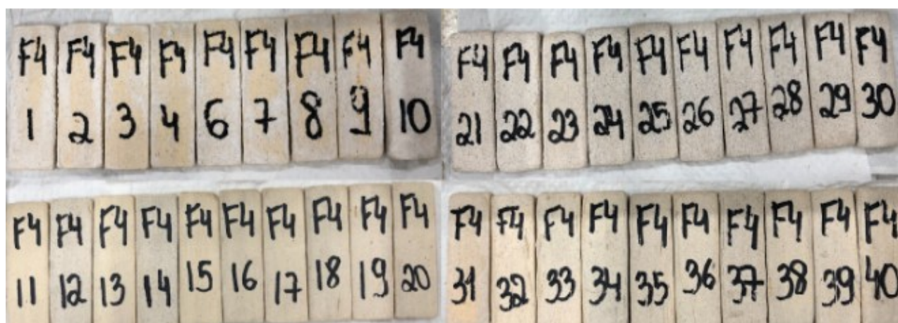
Figura 7 – Sinterização das peças esmaltadas na temperatura de 1200°C – (F4).
