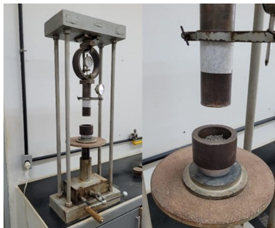
Figura 5 – Moldagem dos corpos de prova.
