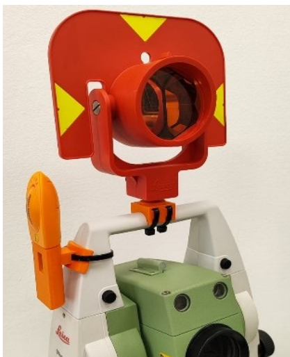
Figura 2 – Instalação prisma na alça da estação total. Fonte: Autores (2024).
