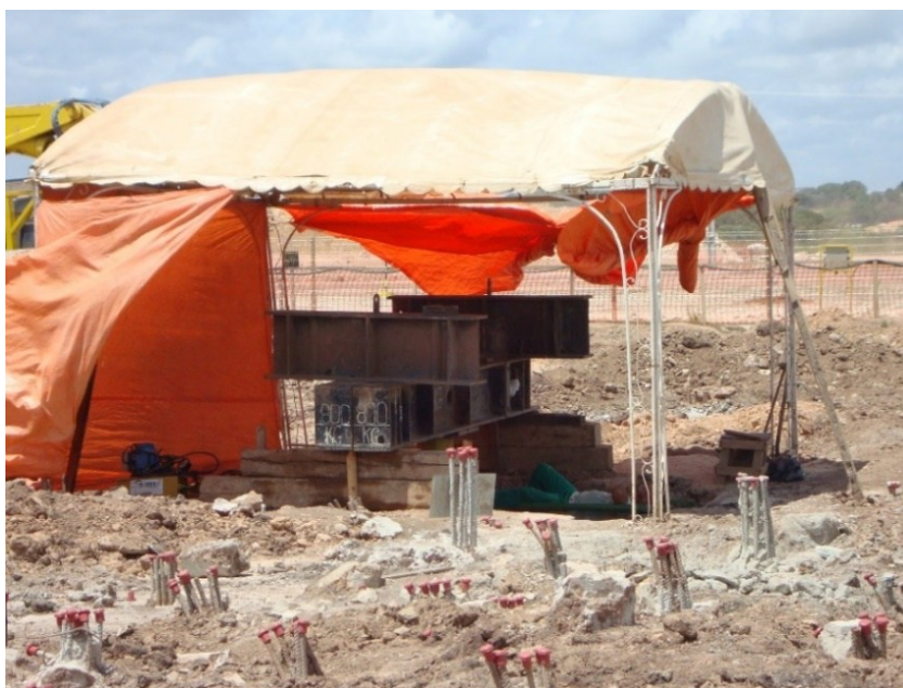
Figura 18 – Estrutura montada para a execução da prova de carga na Petroquímica Suape.
