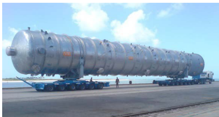
Figura 8 – Transporte e instalação de uma das torres da Petroquímica Suape.
