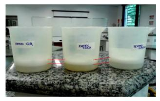
Figura 7 – Formação de espuma em água de OR, água da torneira e água da termodesinfectadora.
